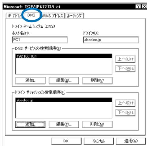
図 5.2.2-16 TCP/IP の設定 (「DNS」タブ)
