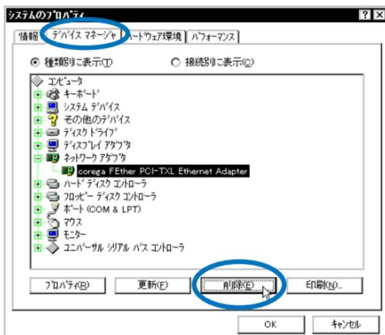
図 4.3-1 ドライバーの削除
