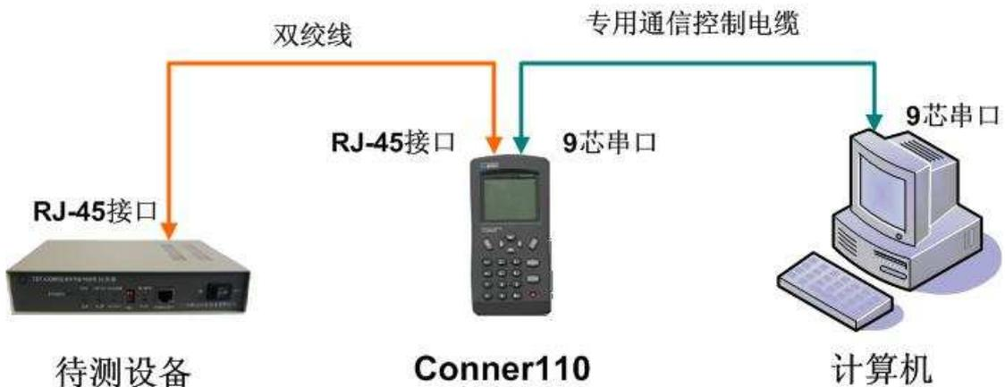
串口设置： 波特率 9600， 数据位 8， 停止位 1， 无流控， 无校验
