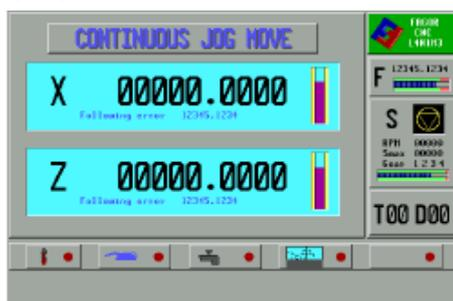
所有这些均是采用 OEM 屏幕，它在 PC 机上用 Fagor Wgdraw 应用软件生成，并用 Fagor Windnc 应用软件发送给 CNC。
