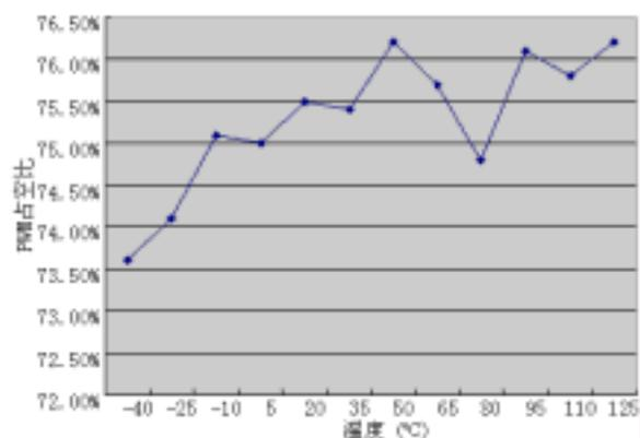
图 8 PWM 最大占空比随温度变化
