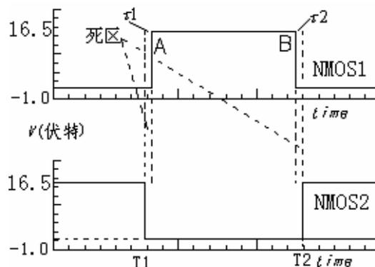
图 16 功率管上的驱动波形
