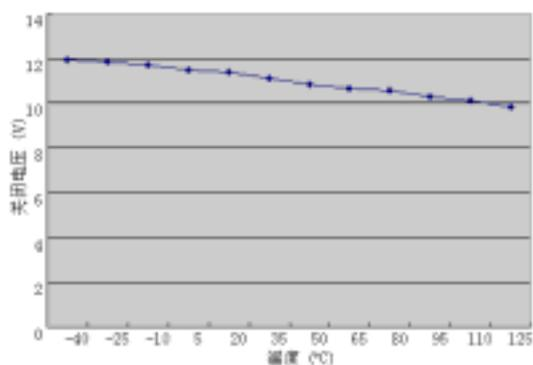
图 4 关闭电压(V<sub>OFF</sub>)随温度变化
