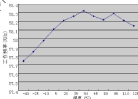
图 7 PWM 振荡频率随温度变化
