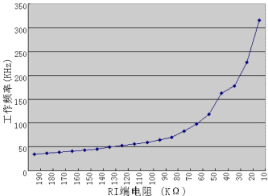
图 10 PWM 工作频率随 RI 电阻的变化
