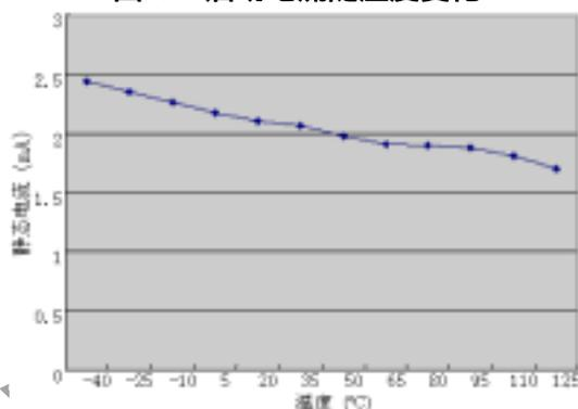
图 5 静态电流随温度变化
