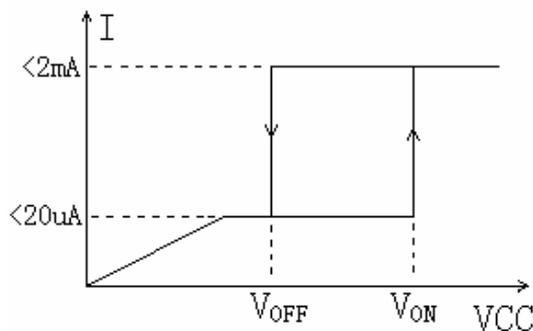
图 12 启动电流&静态电流
