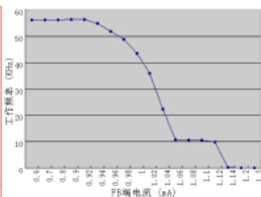
图 9 PWM 频率随 FB 电流变化
