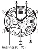
通過查看計時功能中 Ⓡ 秒針的轉動狀態可以瞭解手錶的電力水平。
