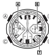
5. 確認 **[6] 右子盤針** 的基準位置正確後，按 **(C)** 鈕。此時手錶進入 **[4] 左子盤針** 的基準位置調整狀態。
