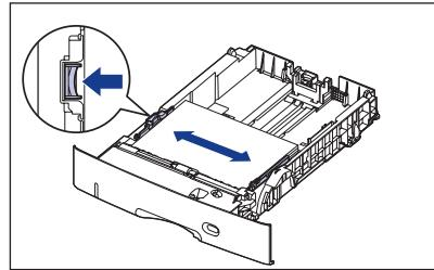
**5** 在按住后面纸张导板的锁定释放杆的同时，将导板滑到装入的纸张大小标记。
