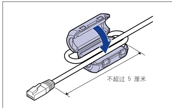
**2** 将 LAN 电缆连接到网卡的 LAN 连接器上。
