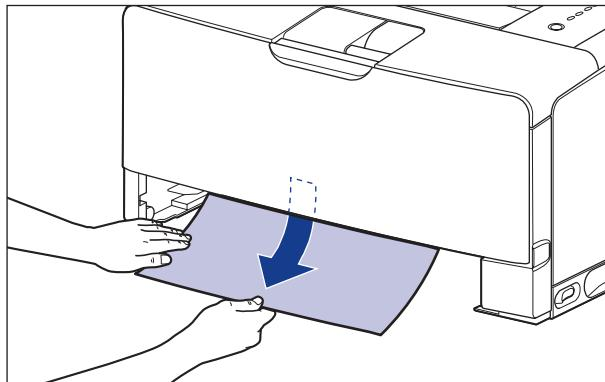
□ 如果进纸器和打印机之间有卡纸, 请将其从打印机中取出。
