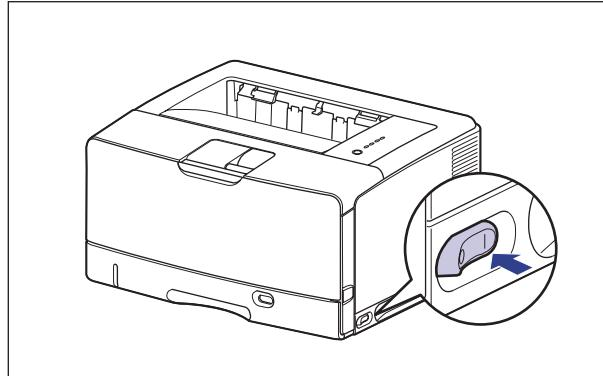
所有指示灯均闪烁，打印机将启动针对打印机组件和可选附件的自我诊断测试。如果在自我诊断测试过程中未发现异常，O（就绪）指示灯（绿色）将亮起，打印机可以开始进行打印了。
