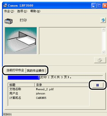
通过单击 [当前打印作业] 选项卡中的 [暂停作业] 按钮，将显示以下消息并选中顶部的 [我的作业操作] 选项卡。
