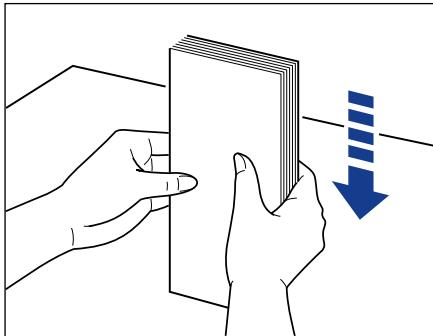
**8** 轻轻放入一叠信封，使其打印面向上，直至纸叠接触到多功能托盘后沿（如下图所示）。
