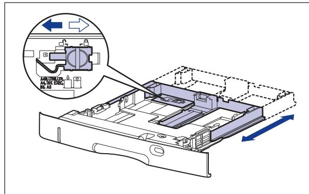
● 在按住两侧纸张导板的锁定释放杆的同时，将导板滑到要装入的纸张大小标记处。
