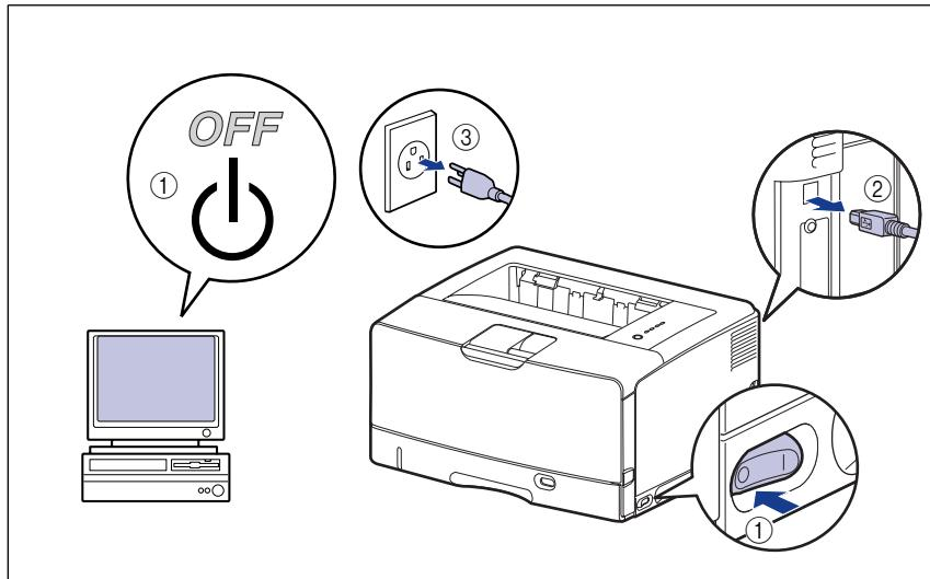
**2** 拔下打印机上的所有接口电缆和电源线。
