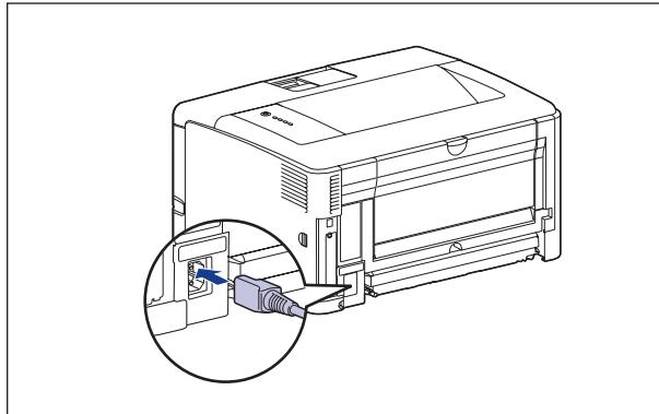
**3** 将电源插头插入 AC 电源插座。
