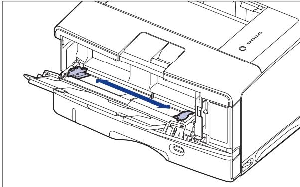
**5 轻轻放入一叠纸，打印面向上，直至一叠纸接触到托盘后沿。**
