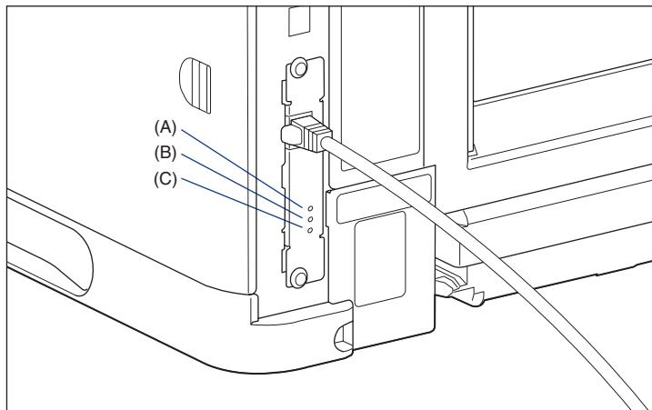
如果网卡不能正常工作，请关闭打印机，然后检查 LAN 电缆连接、集线器运行情况和网卡安装。
