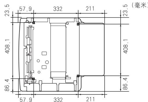
橡胶底座高 1 毫米，顶面尺寸为 12 毫米 × 12 毫米。
