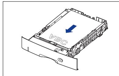
**4** 在按住两侧纸张导板的锁定释放杆的同时，将导板滑到装入的纸张大小标记。
