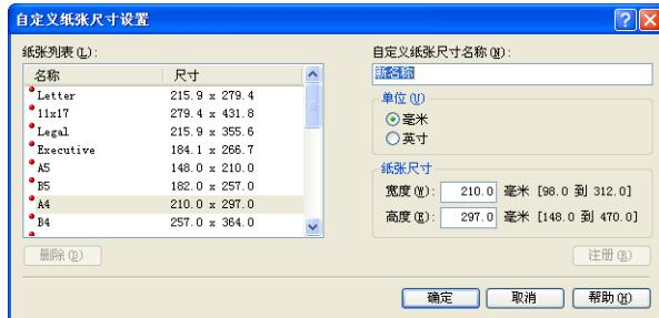
[纸张列表]: 显示标准纸张大小和添加的自定义纸张尺寸的 [名称] 和 [尺寸]。
