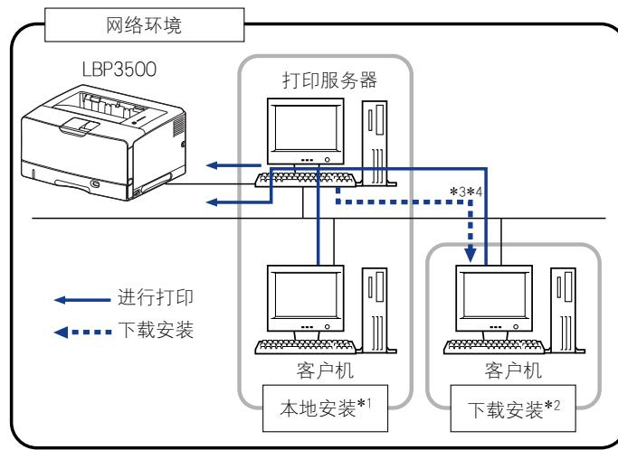
\*<sup>1</sup> 术语“本地安装”表示使用提供的 CD-ROM 安装打印机驱动程序。
