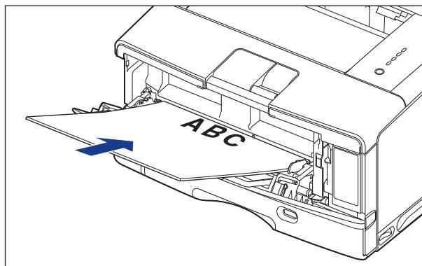
**6** 将纸张导板与纸叠的两侧对齐。
