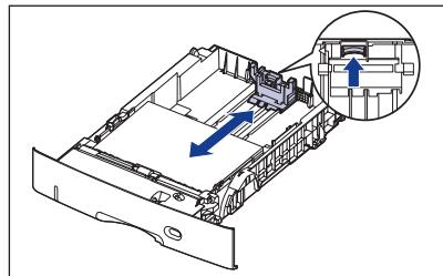
**6** 按下纸张（如下图所示），确保纸叠没有超过装纸限制标记（A），然后将其设置为在纸张导板挂钩（B）的下面。
