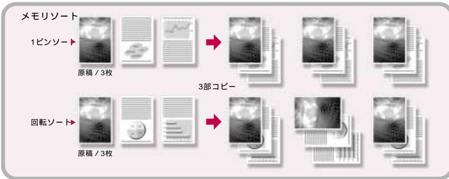
**メモリソート:**メモリ上のデータをソートして出力することで、特にオプションを装着していない場合でもソートが行なえます。また、2つの用紙カセットに、同サイズの用紙をタテ/ヨコにセットすれば、「回転ソート機能」により一部ずつ交互に方向を変えてソートすることもできます。
