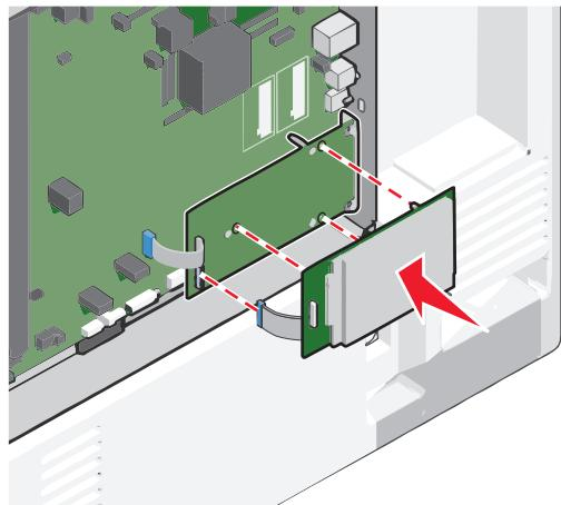
d 将打印机硬盘接口电缆的插头插入 ISP 的插座中。
