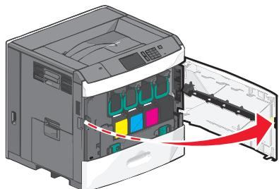
2 抬起绿色手柄并拉住打印碳粉盒。抓住顶部手柄并将碳粉盒提出机器。
