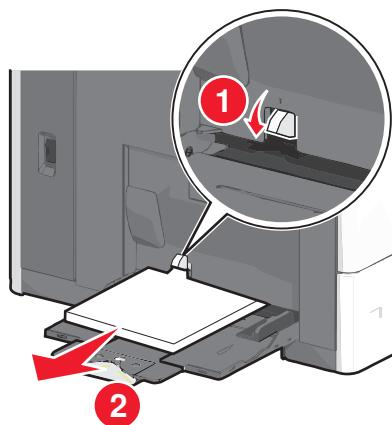
**警告—可能的损坏：**不先推纸张拾取凸片而拉出纸张可能造成纸张拾取凸片断裂。
