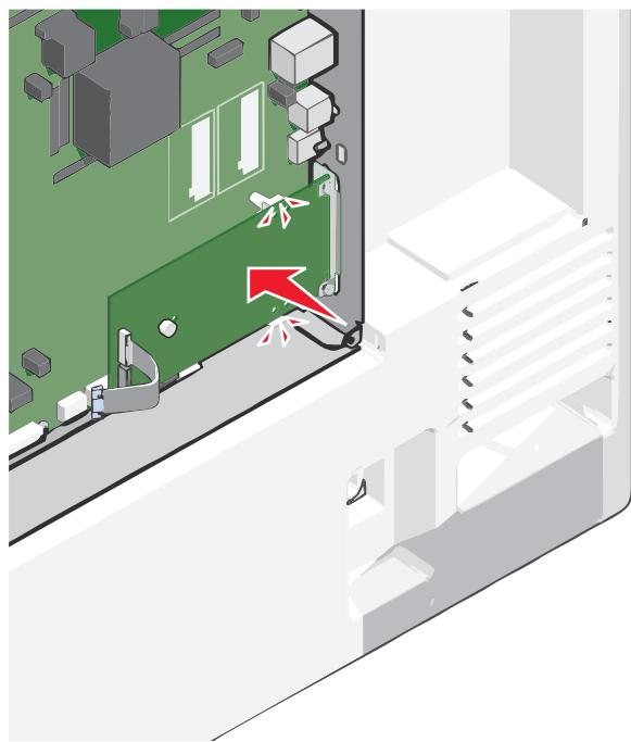
**9** 插入长的翼形螺钉并顺时针旋转使 ISP 固定到位，但是不要拧紧翼形螺钉。
