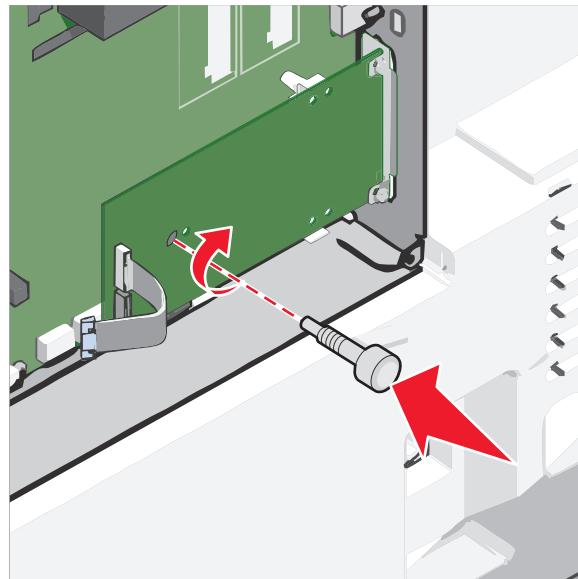
**10** 安装提供的两个螺钉来将 ISP 固定板固定在系统板框架上。
