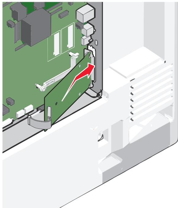
**8** 朝着塑料底座放低 ISP 直到 ISP 被固定在塑料底座的导轨之间。
