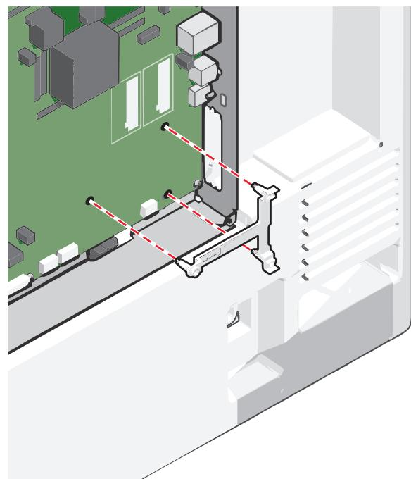
**7** 将 ISP 安装在塑料底座上。使 ISP 在塑料底座上面呈一定角度，然后靠近塑料底座，以便让任何伸出的连接器能通过系统板框架中的 ISP 开口。
