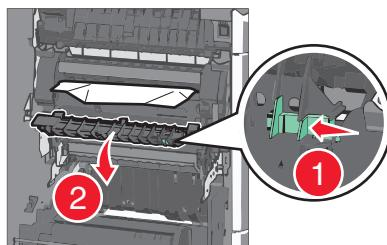
b 用力抓住被卡纸张的两边，然后轻轻地将它拉出。
