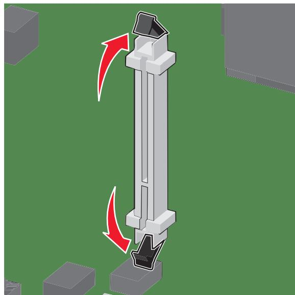
**4** 将内存卡上的槽口与连接器上的凸脊对齐。
