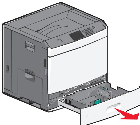
请注意进纸匣底部的尺寸指示器。请使用这些指示器来帮助放置长度和宽度导片。
