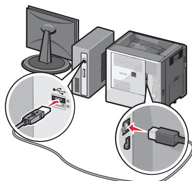
**注意：**打印机被配置后，软件将指导您断开临时的**USB** 电缆连接，这样您可以实现无线打印。
