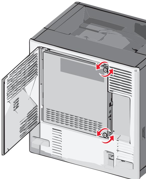
**b** 将金属面板转到左边以使挂钩脱离，然后向前拉来移除它。
