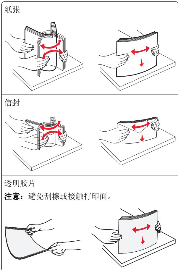
**4** 推纸张拾取凸片，然后加载纸张或特殊介质。将纸堆轻轻地滑入多功能进纸器中，直到它到达挡片，然后松开纸张拾取凸片。
