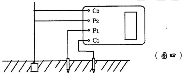
3、测量大型接地网接地电阻时，不能按一般接线方法测量，可参照电流表、电压表测量法中的规定选定埋插点。
