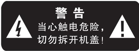
注意:高压!生命危险!为避免有生命危险的触电事故,不得取下机器顶盖或后盖。在机器内部没有用户可修理的部件。修理工作只允许由具备资格的人员进行。如果不使用机器,请拔下电源线。
