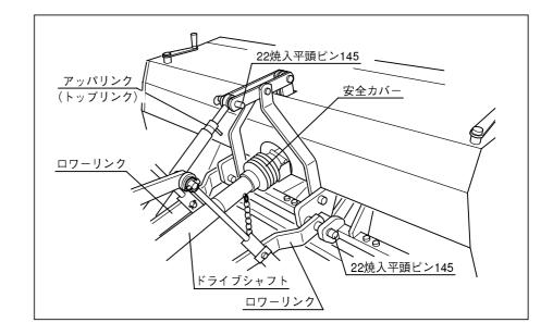
③トラクタのアッパリンク(トップリンク)を作業機に「19平頭ピン100(1 3)」で取付けて、作業機がおおよそ水平になるよううに、アッパリンクを調節してください。
