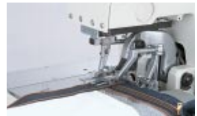
刀X位置修正 (设定值-0.5 - 0.5 mm)
