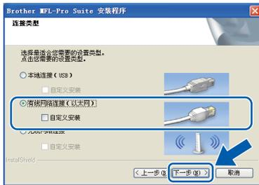
**h** 对于 Windows® XP SP2/Windows Vista® 用户，当出现此屏幕时，选择**更改防火墙端口设置以连接网络和继续安装。(推荐)**，然后点击**下一步**。
