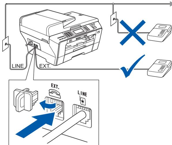
如果有外接应答设备，请将接收模式设置为外接应答设备。请参见第7页上的选择接收模式。更多信息，请参见使用说明书第7章中的连接外接应答设备（电话应答设备）。
