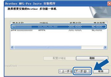
如果设备的 IP 地址栏中显示 APIPA，点击**配置 IP 地址**，并输入适合您网络的设备 IP 地址。
