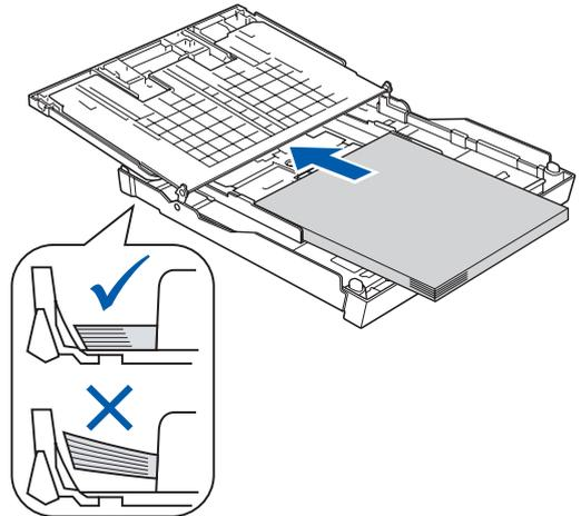
**f** 用双手轻轻滑动纸张宽度导块，调整至纸张尺寸。确保纸张宽度导块触碰到了纸张的两边。
