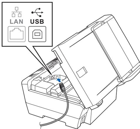
**d** 如下图所示，小心地将 USB 接口电缆嵌入槽内，并顺着槽绕到设备后部。然后将 USB 接口电缆连接到您的计算机上。
