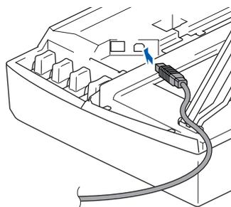
**12** 如下图所示，小心地将 USB 电缆插入电缆槽，并顺着电缆槽绕到本设备的后部。
