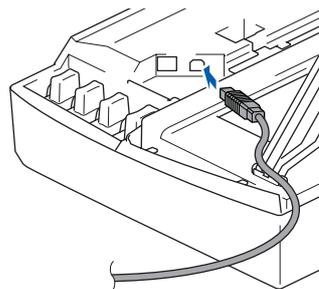
**9** 如下图所示，小心地将 USB 电缆插入电缆槽，并顺着电缆槽绕到本设备的后部。
