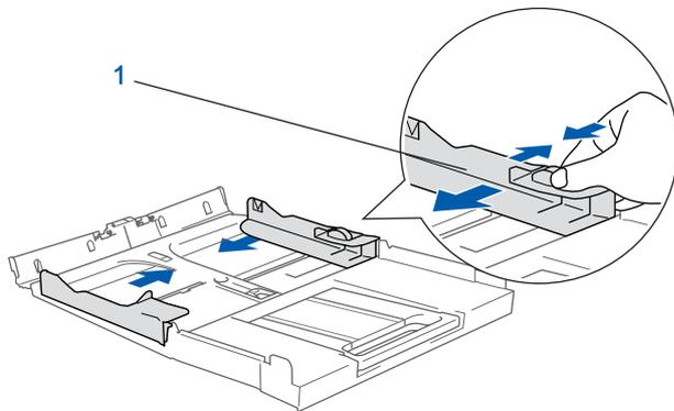
3 拉出纸张支撑板 (1)，同时展开托纸板 (2)。
