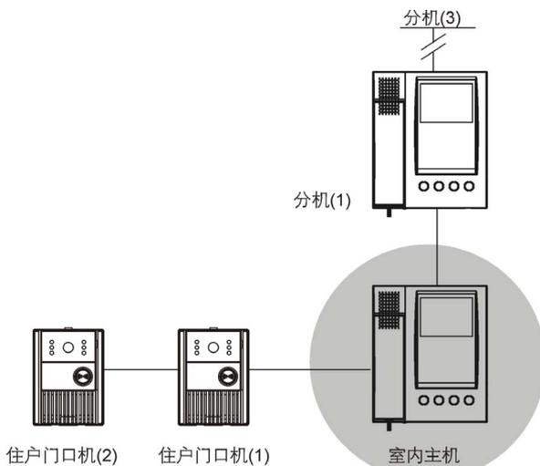
为确保工程质量，请严格按照标准线规要求施工，讯号线要求采用对绞双屏蔽线，视频线要求采用同轴电缆线，CTRL 和 PWR 一对，AUDIO 和 GND 一对。
