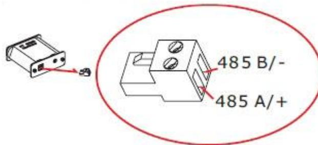
把云台或智能球的 RS485 线连接到无线接收盒的 RS485 接口，把直流 12 伏电源连接到无线接收盒电源接口。
