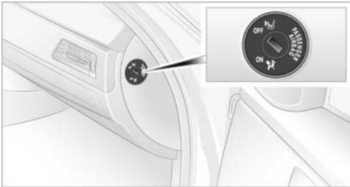
可以用钥匙开关关闭副驾驶员侧前部、侧面安全气囊，并可重新激活。这个开关位于副驾驶员侧仪表板的侧面。
