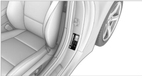
打开驾驶员侧车门即可在门柱上看到已认可的轮胎规格大小的充气压力数据。
