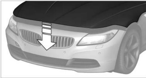
从约 40 厘米高处松手关闭发动机室罩。此时应发出清晰的锁止声。
