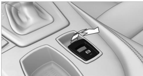
拉动按钮。驻车制动器被确定。
