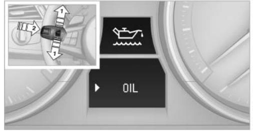
1. 频繁地向上或向下按压闪光灯控制杆上的按钮 1，直至在显示上出现相应的符号和“OIL”为止。
