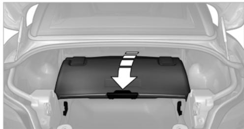
打开硬顶前关闭行李箱分隔装置，箭头，并双向上锁。
