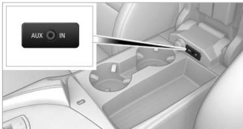
将设备的耳机接口或声音输出接口与塞孔相连接。
