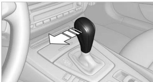
将选档杆从位置 D 向左移至换挡槽 M/S，激活运动模式程序。推荐将这个选档杆位置用于动力型的驾驶方式。
