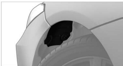
2. 向左旋转车轮罩中的两个塞子并取下灯罩。
