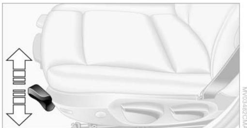
拉动控制杆并移动座椅，直至调整了所需的倾斜度。松开控制杆后轻微向前后移动座椅，以使其正确卡住锁止。
