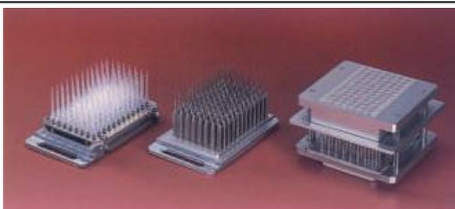
96孔滴头式分液头、喷嘴式分液头、吸筒模块
