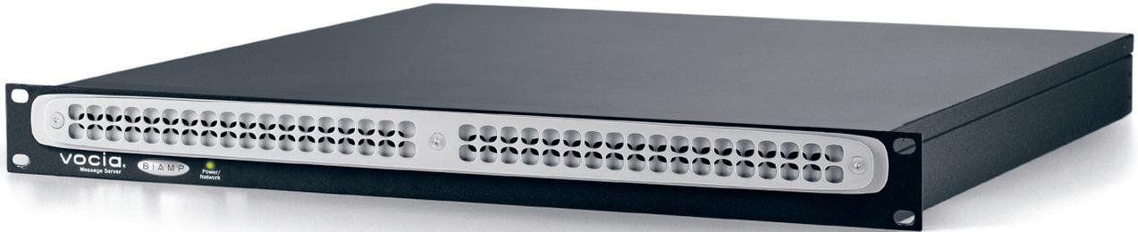
**MS-1** 网络化信息服务器，支持 **Vocia®** 系统内的多种寻呼功能 — 包括语音回放、广播日程安排、**VoIP** 寻呼连接、日志记录和远程控制。除了具有本地存储设备文档之外，实际上 **MS-1** 相当于整个系统设置的中央储存器，对于装置设置和替换具有即插即用的功能。**MS-1** 在 **Vocia** 系统中的功能通过以太网控制协议和 **CobraNet®** 协议得以实现。另外，**MS-1** 还支持内部寻呼，并能通过 **TCP/IP** 在界与界之间进行沟通。
