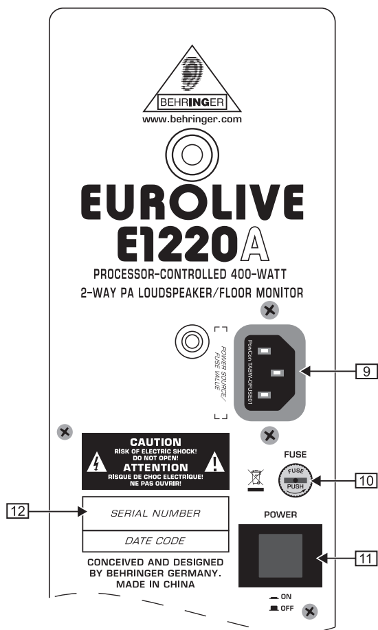
图 2.2: 操作元件和接口 E1220A和E1520A)
