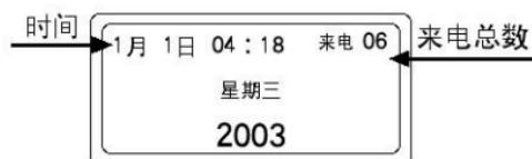
平时显示状态，“1月1日”表示月、日，“04：18”表示时间，“06”表示来电总数，“星期三”表示星期数，“2003”表示年。
