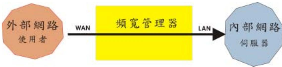
将外部网络使用者通过频宽管理器的至内部网络服务器及 各种通讯服务 下载 / 上传 流量所做的统计
