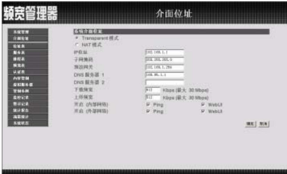
图 S-2 键入 Transparent Mode 相关 IP 地址
