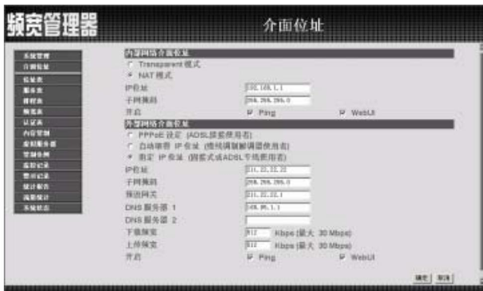
图 2-4 指定 IP 地址(固接式或 ADSL 专线使用者)设定
