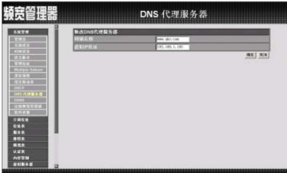
图 1-38 变更 DNS 代理服务器
