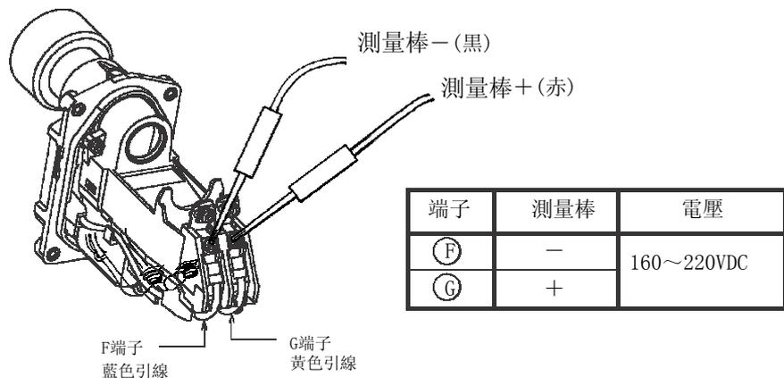
》如果電壓為160V~220VDC，表示接線正確。DC電壓為負時，表示F端子、G端子接線的極性相反。
