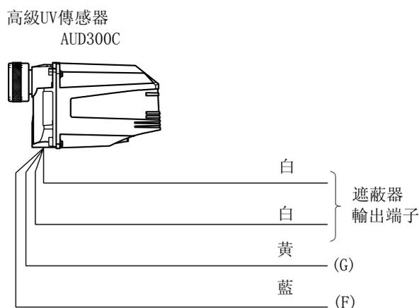
與AUR連接的所有引線，請務必放在電線管及導管分線匣內。同時，與其他動力線放在不同的線槽內。
