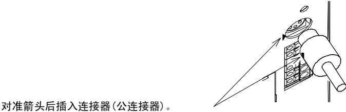
图 5 手操器（Data Setter）/PC-MMI 的连接
