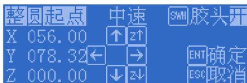
此外，还可以通过插入图形功能，根据计算好的数值设置整圆直径，然后直接插入整圆。
