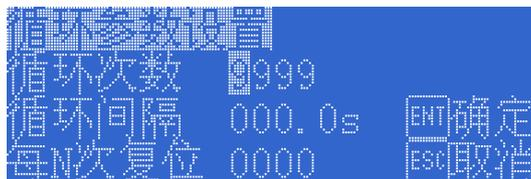
图 4-5 循环参数设置界面
