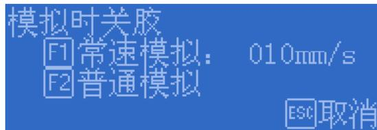
选择模拟时关胶速度后，进入模拟加工界面，按“**F4**”即可设置循环参数，包括循环次数，循环间隔以及每 N 次复位。
