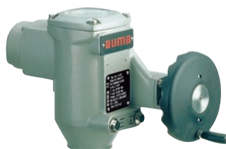
部分回转电动执行器 AS 6 - AS 50 扭矩 25 至 500 Nm 90 度转动时间 4 至 90 s
