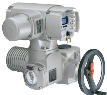
装配 AUMATIC 控制装置的 多回转电动执行器 SA/SAR 最大扭矩 10 至 1,000 Nm 速率 4 至 180 rpm
