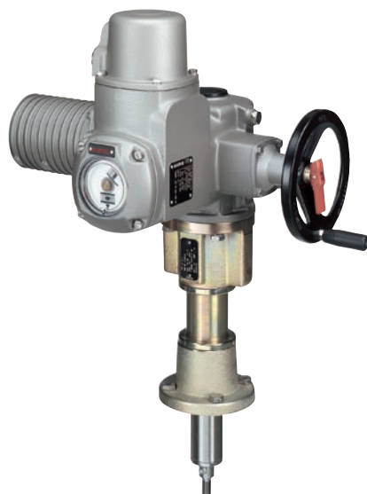
装配线性推力单元 LE 的 多回转电动执行器 SA/SAR 推力 4 kN 至 217 kN 最大行程 500 mm 线性速率 20 至 360 mm/min
