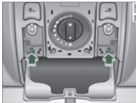
图 61 前车顶部视图： 拆卸照明单元
