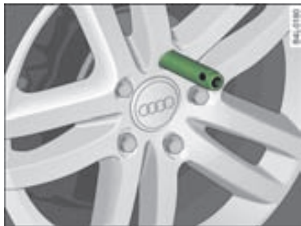
图 345 更换车轮：最上面一个孔内的定位销
