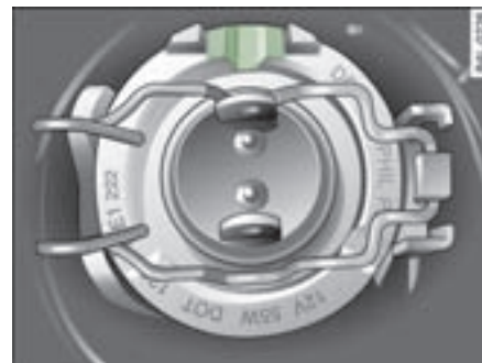
图 375 带固定弓的灯泡 — 导向凸缘已被标记 ▶
