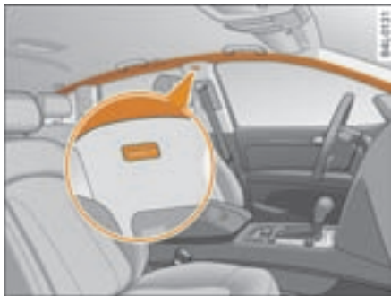
图 285 车门上方头部安全气囊的安装位置
