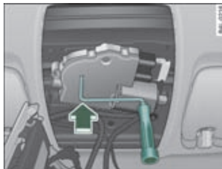
图 62 前车顶部视图： 用于应急操纵的曲柄
