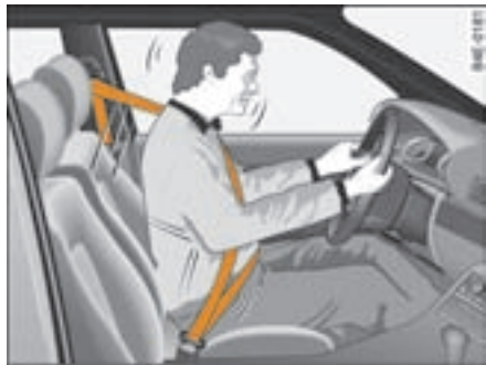
图 266 已系好安全带的驾驶员在突然刹车时被正确系上的安全带拉住
