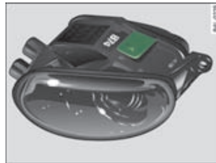
图 374 带固定拉条（上边）和固定凸缘的雾灯
