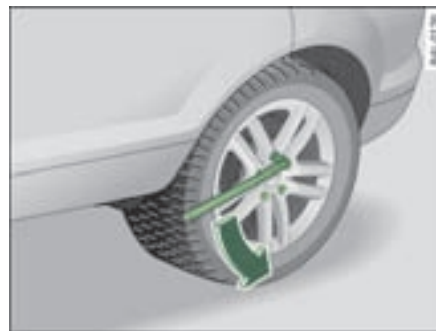
图 342 更换车轮：松开车轮螺栓
