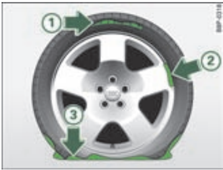
图 348 不适合使用轮胎修理系统的轮胎损坏情况
