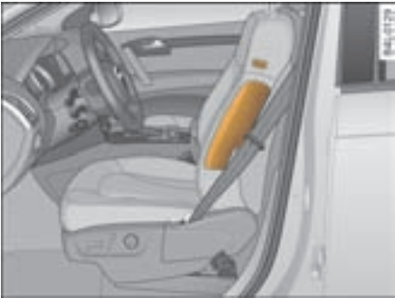
图 283 驾驶员座椅上侧面安全气囊的安装位置
