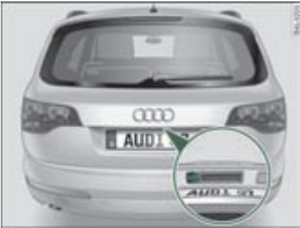
图 235 行李箱盖：倒车摄像机的安装位置
