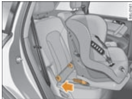
图 296 将 ISOFIX 儿童座椅推向已安装好的锥形套管
