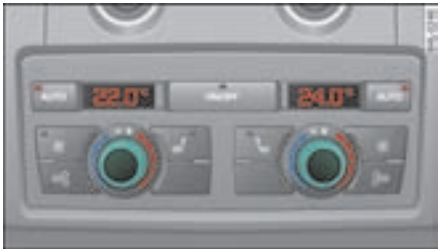
图 163 后座空调器操作元件：调节温度
