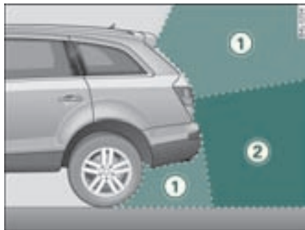
图 240 侧视图：无法观察的范围①和倒车摄像机的观察范围②
