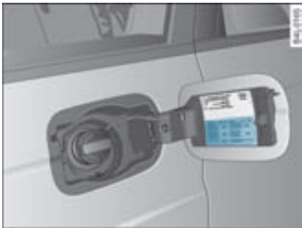
图 328 汽车侧面，已打开的油箱盖板，上面有轮胎充气压力数据表
