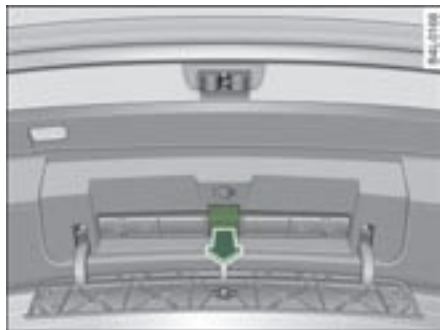
图 332 尾门中开着的警告三角标志盖板
