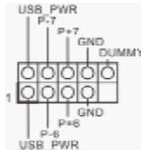
除了位于 I/O 面板的六个默认 USB 2.0 接口之外，这款主板有三组 USB 2.0 接针。这组 USB 2.0 接针可以支持两个 USB 2.0 接口。
