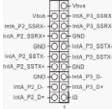
除了位于 I/O 面板的两个默认 USB 3.0 接口之外, 这款主板有一组 USB 3.0 接针。这组 USB 3.0 接针可以支持两个 USB 3.0 接口。
