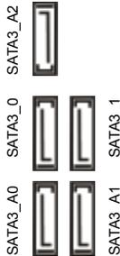
这里有五组 Serial ATA3 (SATA3) 接口支持 Serial (SATA) 数据线作为内部储存设置。目前 SATA3 界面理论上可提供高达 6.0Gb/s 的数据传输速率。
