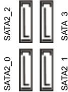
这里有四组 Serial ATA2 (SATA2) 接口支持 Serial (SATA) 数据线作为内部储存设置。目前 SATA2 界面理论上可提供高达 3.0Gb/s 的数据传输速率。
