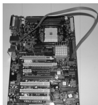
Connectez le câble de données SATA au connecteur SATAII rouge (eSATAII_BOTTOM)
