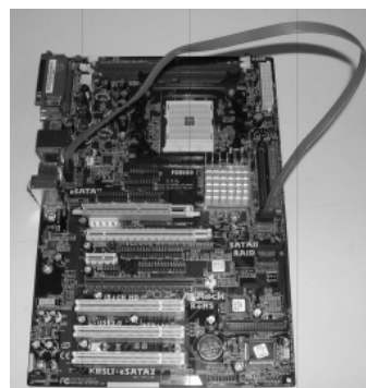
Conecte el cable de datos SATA al conector rojo eSATAII (eSATAII_ BOTTOM)
