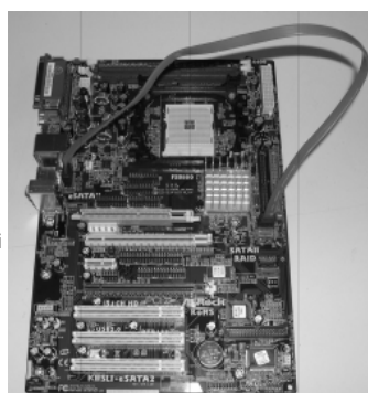
Collegare il cavo dati SATA al connettore eSATAII rosso (eSATAII_BOTTOM)
