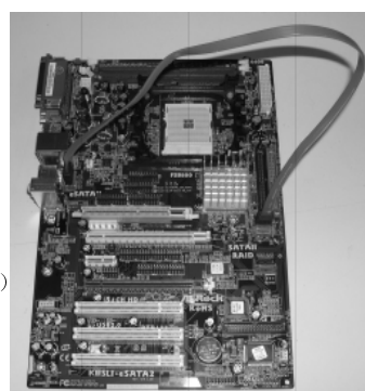
将 SATA 数据线连接 到红色的 eSATAII 接口 (SATAII_BOTTOM)
