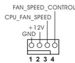
请将 CPU 风扇连接线接到这个接头, 并让黑线与接地的针脚相接。
