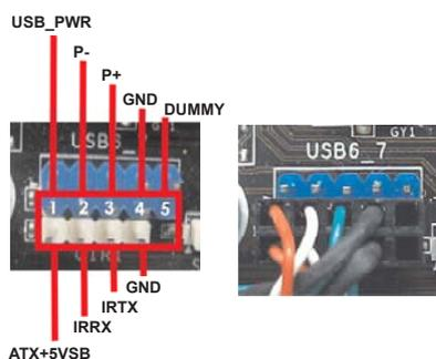
步骤 3. 将多角度 CIR 接收器安装到前部 USB 端口。如果多角度 CIR 接收器无法成功从 MCE 遥控器接收红外线信号，请试着将其安装到其他前部 USB 端口。
