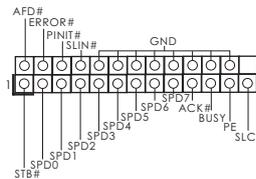
这是一个连接打印机端口的接口，方便您连接打印机设备。
