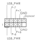
除了位于 I/O 面板的两个默认 USB 2.0 接口之外，这款主板有三组 USB 2.0 接针。这组 USB 2.0 接针可以支持两个 USB 2.0 接口。
