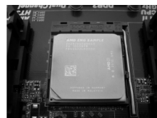
步骤 4： 下推并锁住插座拉杆
