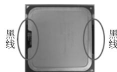
步骤 2-2. 将有 IHS (Integrated Heat Sink, 集成散热片) 的一面朝上。找到第 1 针和两个方向标志的凹口。
