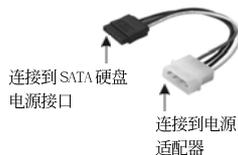
请将 SATA 电源线黑色的一端连接到 SATA 驱动器的电源接口。然后将 SATA 电源线白色的一端连接到电源适配器的电源接口。
