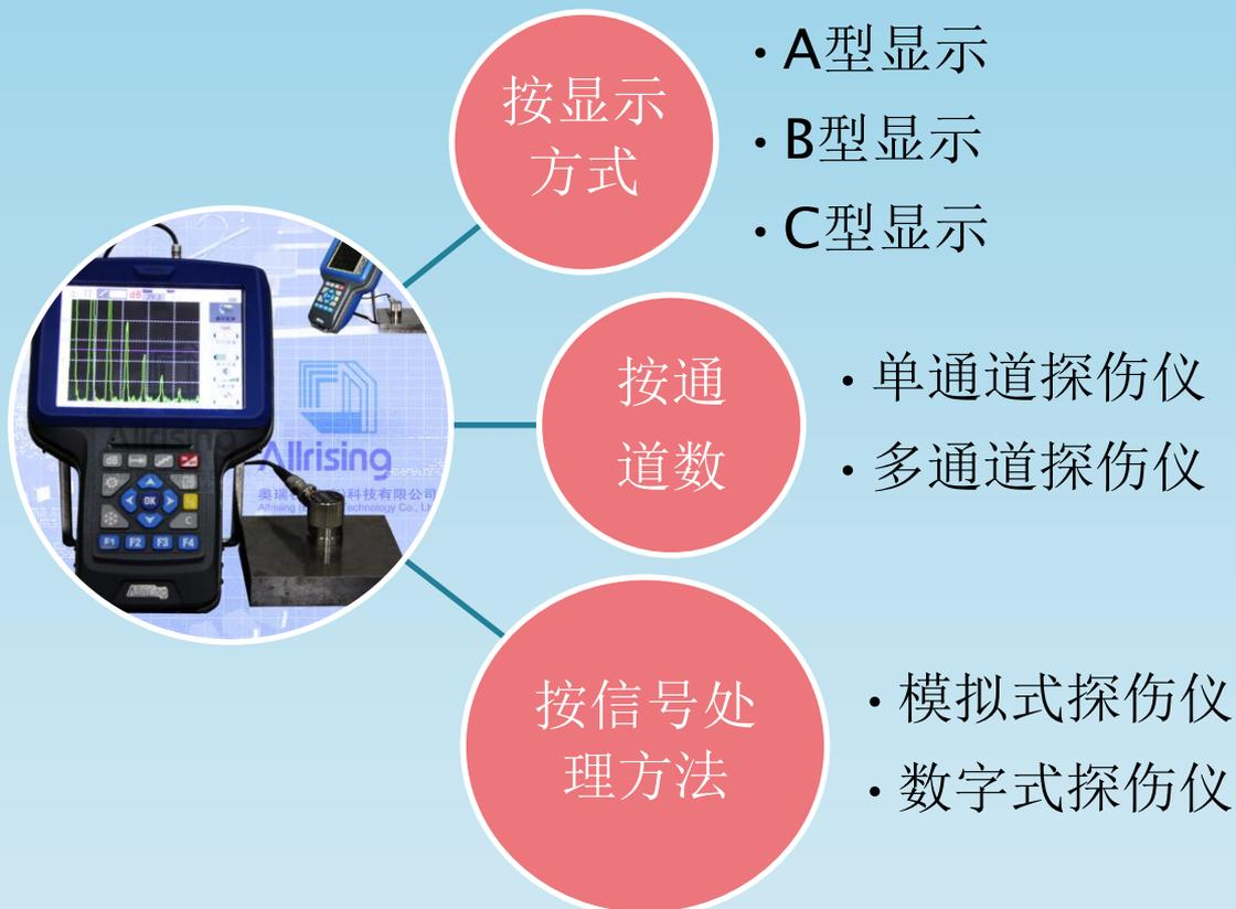
ARS200系列属于数字式双通道A型真彩显示超声波探伤仪，同时具有B型显示功能、支持C扫描（附带编码器输入接口）
