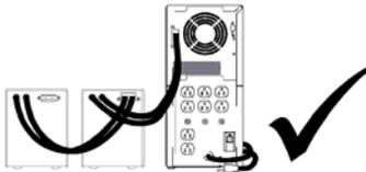
正确地完成安装带有二个电池组的 XL 机型。
