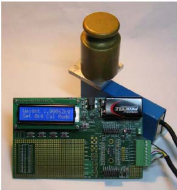
图2.采用 AD7192 的电子秤系统
