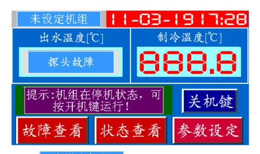
图中 未设定机组 显示的设定的机组类型,本控制器支持4种机型,分别是水冷冷水、水冷冷热、风冷冷水、风冷热泵;【机组类型在系统参数中由厂家设定】
