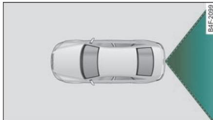
图 172 俯视图: 倒车摄像头的探测范围
