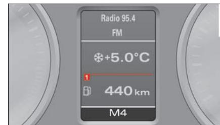
图 164 显示屏：手动换档 (tiptronic 手动电控换档程序)
