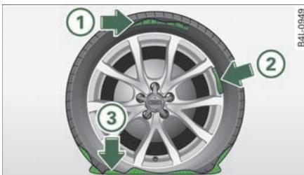
图 257 不适合使用轮胎应急套件的轮胎损坏情况
