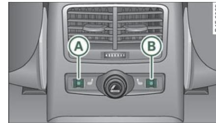
图 112 中控台后部：座椅加热
