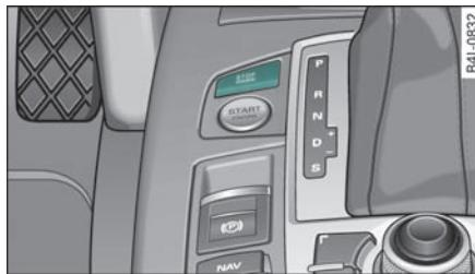
图 120 中控台：发动机关闭按钮
