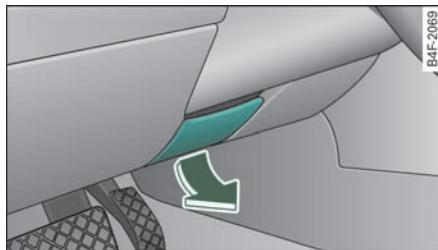
图 114 转向柱下面的拨杆
