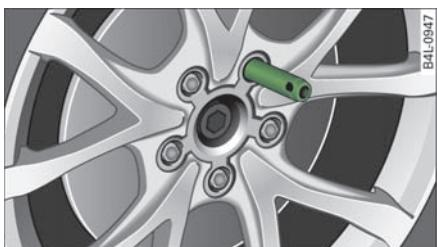
图 255 更换车轮: 最上面一个孔内的定位销
