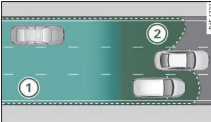
图 152 示意图：传感器的探测范围
