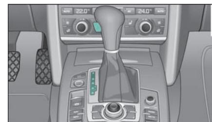
图 160 中控台局部视图：带有锁止按钮的选档杆
