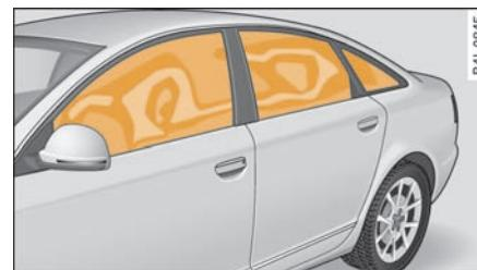
图 207 已胀开的头部安全气囊
