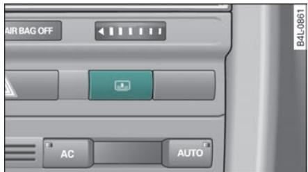
图 56 驾驶员舱：后窗玻璃的遮阳卷帘按钮
