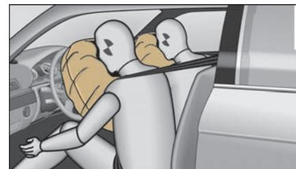
图 202 已胀开的前部安全气囊
