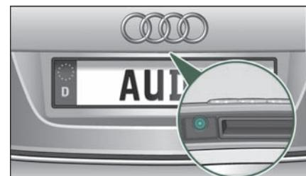
图 174 行李箱盖: 倒车摄像头的安装位置
