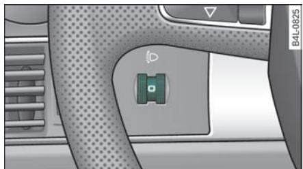
图 43 仪表板：照明距离调节装置调节轮\*
