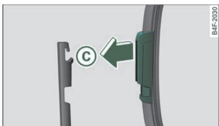
图 59 安装车窗玻璃刮水片
