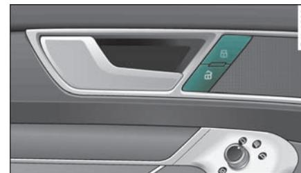
图 25 驾驶员车门：中央门锁开关
