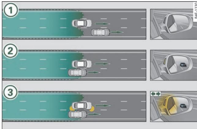
图 155 side assist 行驶换道辅助系统：有车辆被慢速甩开
