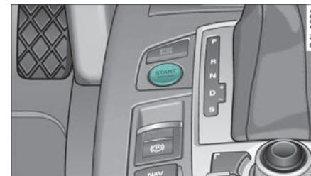
图 119 中控台：发动机起动按钮
