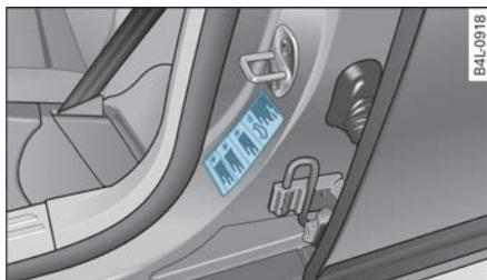
图 238 已打开的驾驶员车门及轮胎充气压力数据表
