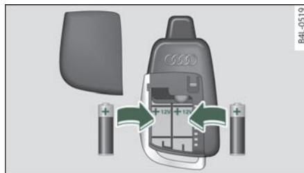
图 109 更换无线遥控器的电池
