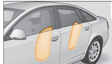
图 205 已胀开的侧面安全气囊
