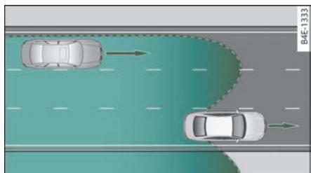
图 159 狹窄车道：行驶换道辅助系统可能对隔道行驶的车辆作出反应
