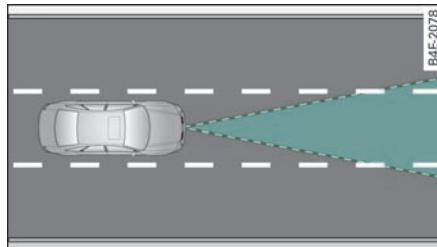
图 127 雷达测距传感器的探测范围
