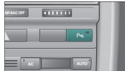
图 168 中控台：驻车辅助开关
