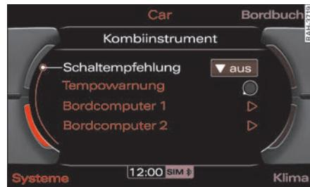
图 11 显示屏：打开 / 关闭换档建议显示
