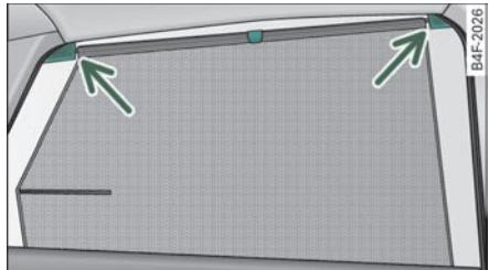
图 55 后座车门上已上拉的卷帘
