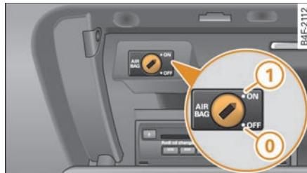
图 208 手套箱中用于关闭副驾驶员安全气囊的钥匙开关
