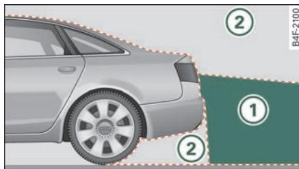
图 173 侧视图: 倒车摄像头的探测范围 ① 和没有探测到的范围 ②
