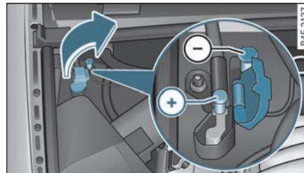
图 236 发动机舱：充电装置和辅助起动电缆的接 口
