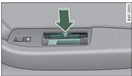
图 71 后车门饰板：后部烟灰缸
