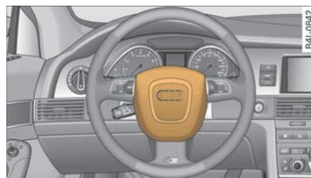
图 200 方向盘内的驾驶员安全气囊
