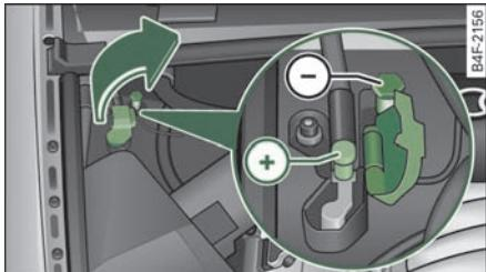
图 259 发动机舱：充电装置和辅助起动电缆的接口
