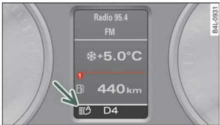
图 46 远光灯辅助系统的指示灯
