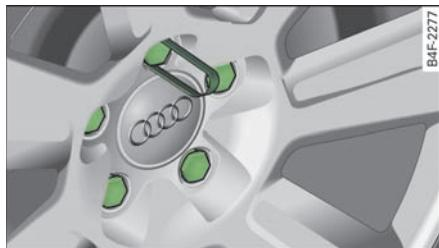
图 250 更换车轮：拆下
