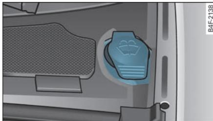
图 237 发动机舱：车窗玻璃清洗液储罐
