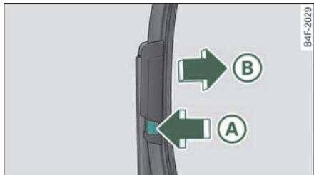
图 58 拆卸车窗玻璃刮水片
