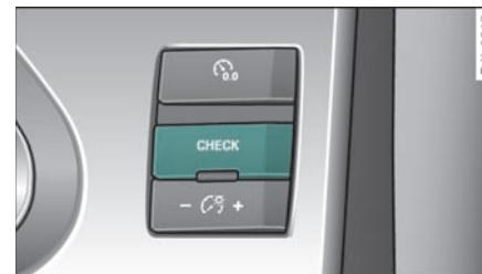
图 122 组合仪表局部视图：CHECK（检测）按钮
