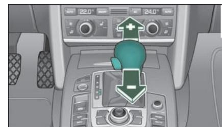
图 163 中控台：手动换档 (tiptronic 手动电控换档程序)
