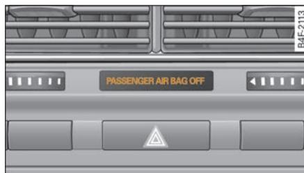
图 209 在用钥匙开关关闭副驾驶员安全气囊时的警告灯
