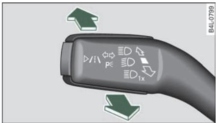
图 45 用于操控远光灯辅助系统的转向灯操纵杆
