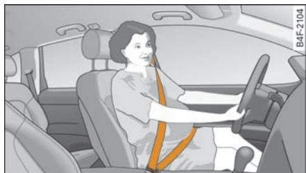
图 197 孕妇系带安全带的方式
