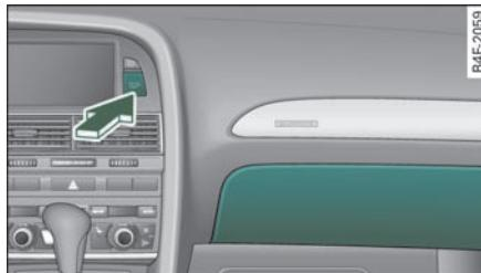
图 77 中控台：手套箱的开锁按钮
