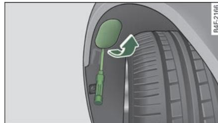
图 266 前部车轮罩：靠近前部转向信号灯灯泡
