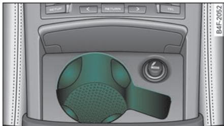
图 75 中控台：前部饮料罐托架
