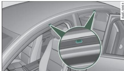
图 80 用于车顶行李架的固定点
