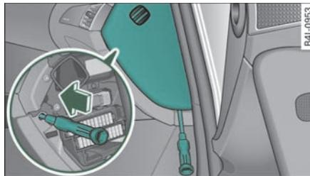
图 78 仪表板右侧：手套箱应急开锁
