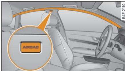
图 206 车门上方头部安全气囊的安装位置
