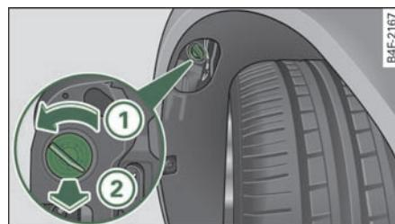
图 267 前部车轮罩：拆卸前部转向信号灯灯座
