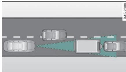
图 141 前方行驶的车别在雷达测距传感器的识别范围之外
