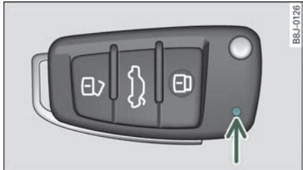
图 20 无线遥控钥匙中的指示灯
