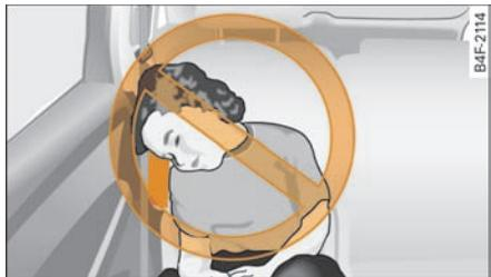
图 210 侧面安全气囊展开部位的危险坐姿图解
