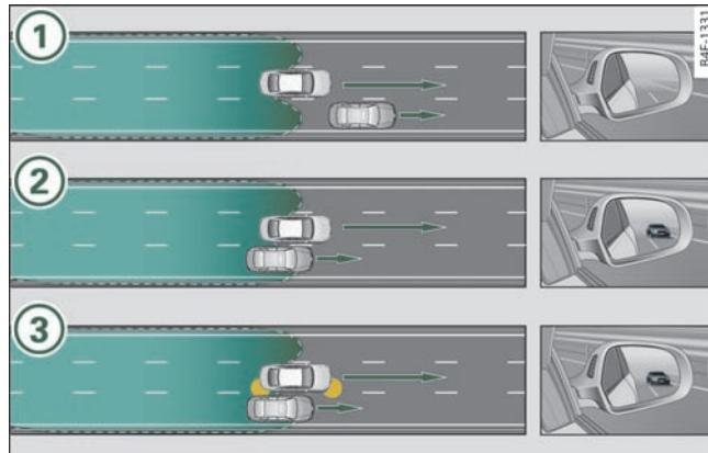
图 156 side assist 行驶换道辅助系统：有车辆被快速甩开
