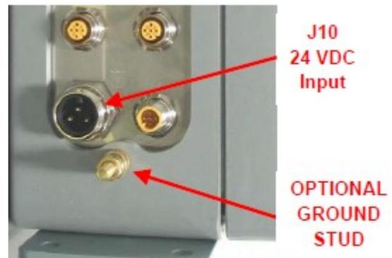
FIGURE 10 – GYRO CONTROL BOX
