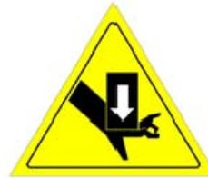
当陀螺减摇器进动时，存在绕万向轴的较大力矩。因此，必须将陀螺减摇器安装在隔离罩中，或在陀螺进动时防止人员或齿轮装置与陀螺减摇器接触。
