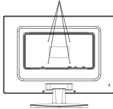
\* 注：请使用附有 M4mm x 12mm(L) 螺丝的 UL 认证墙上安装支架。
