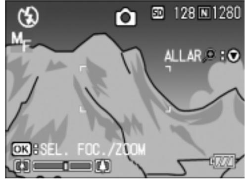
Ogni volta che il tasto OK viene premuto, la barra della messa a fuoco e la barra dello zoom appaiono alternativamente.
