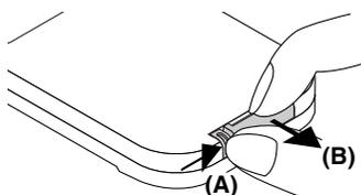
2 古い電池を外し、新しいボタン電池の+面を上にして、電池ケースに入れます。
