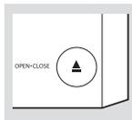
3 放入一张光碟 (印刷商标面朝上)，并再按 **OPEN•CLOSE** 关闭 CD 门盖。
