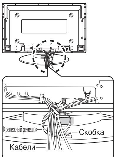
Убедившись в том, что имеется достаточное провисание шнура для минимизации натяжения, плотно свяжите в пучок все кабели с помощью прилагаемого крепежного ремешка.
