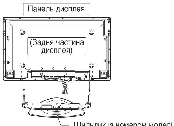
Розташуйте п'єдестал стороною з шильдиком до заду. Вставте дисплей на п'єдестал до кінця.
