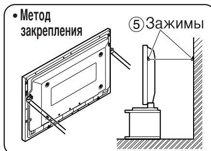
\* Надежно прикрепите к стене, колонне или к подобной твердой поверхности, используя приобретенные отдельно изделия, такие как шнурки или цепи соответствующей прочности.
