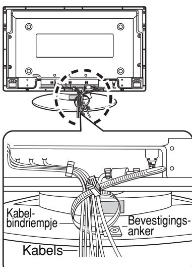
\* Controleer of de kables niet te strak zitten en maak dan alle kabels met het bijgeleverde kabelbindriempje vast.
