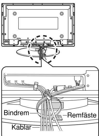
\* Kontrollera att det finns tillräckligt med frigång för kabeln så att den inte utsätts för tryck och bind samman alla kablar ordentligt med den medföljande bindremmen.
