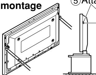
\* Fixez solidement à un mur, un pilier ou une structure solide similaire en utilisant des produits obtenus séparément, tels que des codes ou des chaînes d'une force suffisante.
