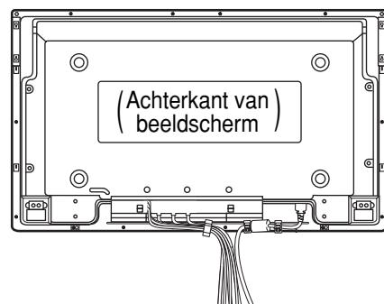
\* Leg schone dekens of iets dergelijks op een vlakke vloer of tafel. Leg dan het apparaat met het scherm naar beneden erop neer.
