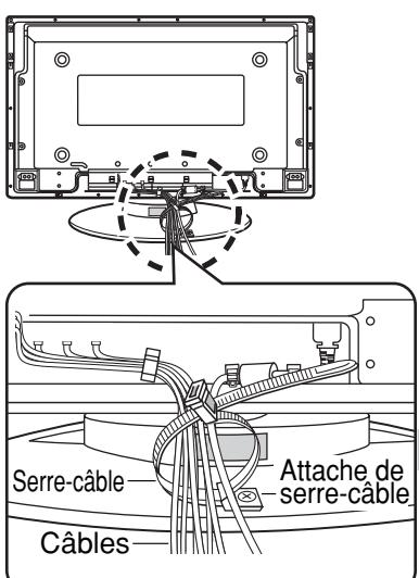
\* Tout en vous assurant que les câbles possèdent suffisamment de mou pour ne pas être sous contrainte, maintenez-les soigneusement ensemble en utilisant le serre-câble fourni.
