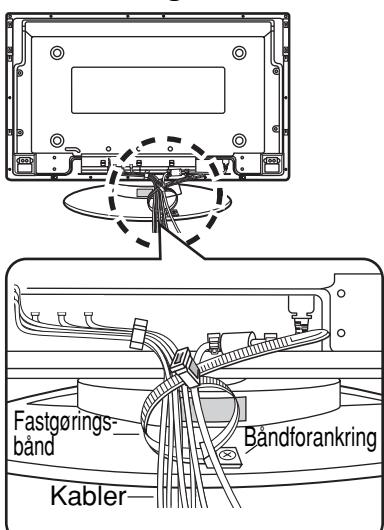
\* Mens det sikres, at der er tilstrækkelig slæk på ledningen, så den ikke udsættes for unødig belastning, samles alle kabler stramt med det medfølgende fastgøringsbånd.
