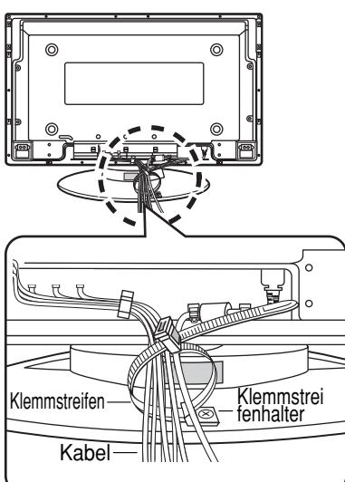
\* Um eine Belastung der Kabel zu vermeiden, sollte sichergestellt werden, dass sie ausreichend Spielraum haben und sie dann mit den anderen Kabeln mit dem mitgelieferten Klemmstreifen fest gebündelt werden.
