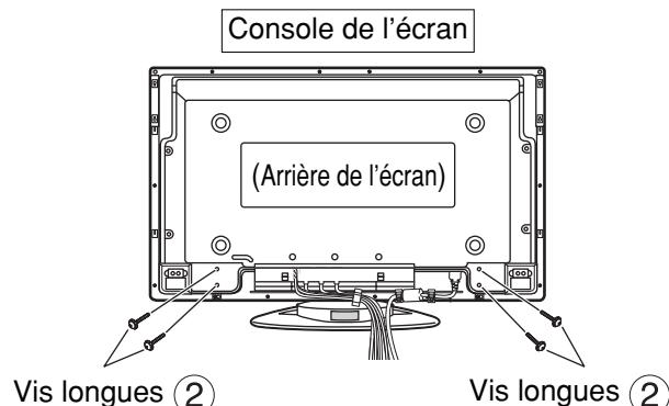
Assurez la fixation en utilisant des vis longues ②.
