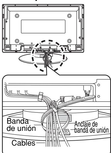
\* Asegúrándose de que los cables queden lo suficientemente flojos como para reducir al mínimo el esfuerzo, una firmemente todos los cables con la banda de unión suministrada.
