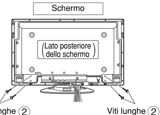
Fissare saldamente per mezzo delle viti lunghe ②.
