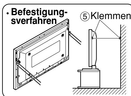
\* An einer Wand, einem Balken oder ähnlichen stabilen Gegenstand unter Verwendung von im Handel erhältlichen Produkten wie Schnur oder Kette von entsprechender Länge sicher anbringen.
