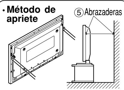
\* Colóquela firmemente en una pared, columna o estructura sólida similar, empleando productos obtenidos separadamente como, por ejemplo, cables o cadenas que tengan suficiente resistencia.
