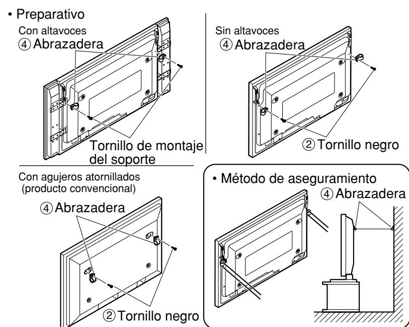
\* Utilice un cable o cadena fuerte de venta en los comercios para asegurar la Pantalla Panorámica de Plasma a una parte sólida de la pared o pilar.
