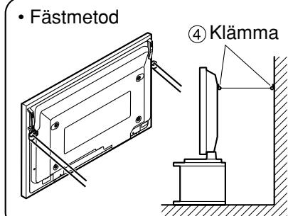
\* Använd stark kabel eller kedja som är tillgänglig i handeln för att fästa bred plasma-monitor till ett starkt parti av väggen eller pelaren.
