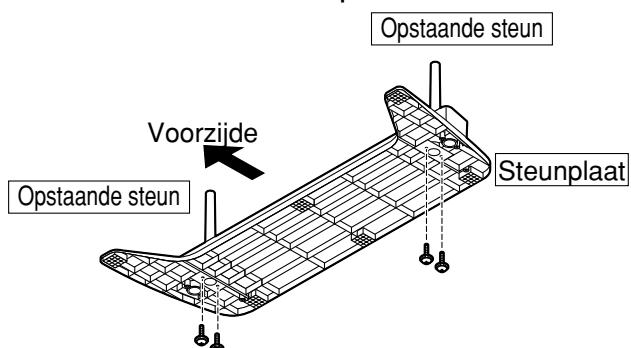
Gebruik de montageschroeven ① om de opstaande steunen stevig aan de onderzijde van de steunplaat te bevestigen.
