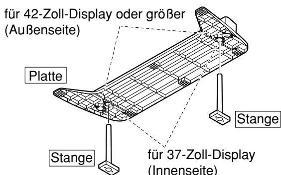
Setzen Sie die Stangen richtig in die beidseitigen Löcher auf der Unterseite des Sockels ein, wie in der obenstehenden Abbildung gezeigt.
