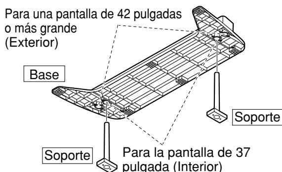
Inserte los soportes en los orificios izquierdo y derecho en el lado inferior de la base para que queden firmemente fijados tal como en la figura anterior.
