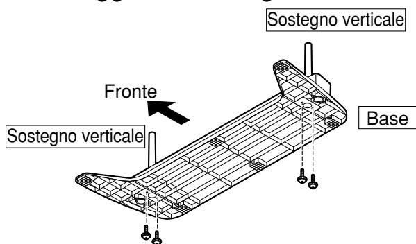
Utilizzare le viti di assemblaggio ① per fissare i sostegni verticali alla parte inferiore della base.
