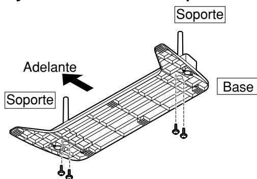
Utilice los tornillos de montaje ① para asegurar firmemente los soportes en la parte inferior de la base.
