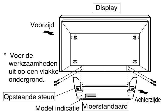
Gebruik de montageschroeven ② (Zwarte schroef) om de display stevig te bevestigen. Plaats de display zodanig dat de zijde waar de gaten voor het insteken van de opstaande steunen zichtbaar zijn zich aan de achterzijde bevindt. Lijn vervolgens de gaten in de display uit met de opstaande steunen en steek de opstaande steunen in de gaten.
