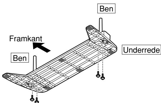
Använd monteringsskruvarna ① för att fästa benen ordentligt vid underredets undersida.
