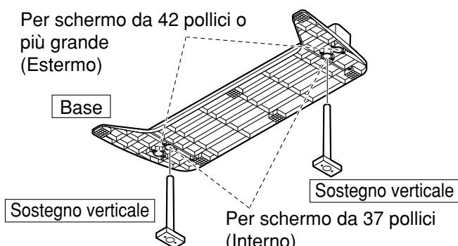
Inserire i sostegni verticali nei fori di destra e sinistra, sotto la base, in modo che l'installazione sia ben salda, facendo riferimento all'illustrazione sotto.
