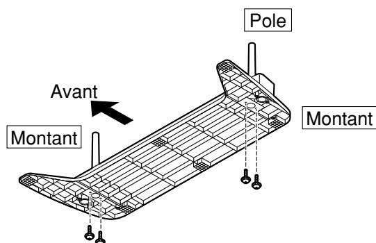
Utilisez les vis de montage ① pour fixer les montants solidement sur la partie inférieure de la base.
