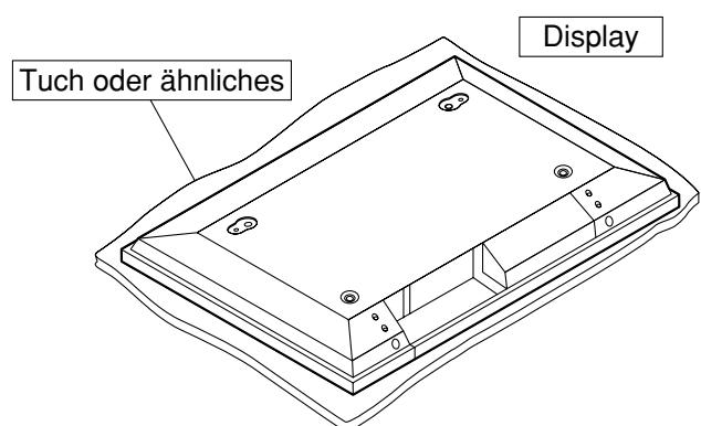
Breiten Sie auf einer ebenen Fläche ein sauberes Tuch aus und legen Sie das Display mit der Bildschirmseite nach unten gerichtet darauf ab.
