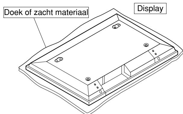
Spreid een schone deken of een soortgelijk materiaal uit op een vlakke ondergrond of tafel en leg de display met de voorzijde naar beneden erbovenop.
