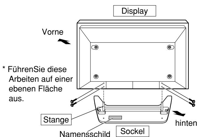
Verwenden Sie zum Befestigen die Schrauben ② . Richten Sie das Display so aus, daß die Löcher für die Stangen nach hinten gerichtet sind. Richten Sie die Löcher auf die Stangen aus und stecken Sie die Stangen hinein.
