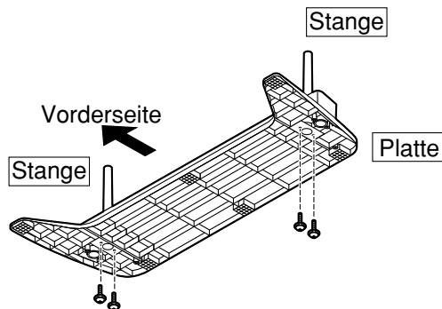
Befestigen Sie die Stangen mit den Schrauben ① an der Unterseite der Platte.
