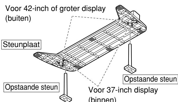
Steek de opstaande steunen in de linker en de rechter openingen aan de onderkant van de steunplaat en montereer deze stevig op hun plaats zoals aangegeven in bovenstaande afbeelding.
