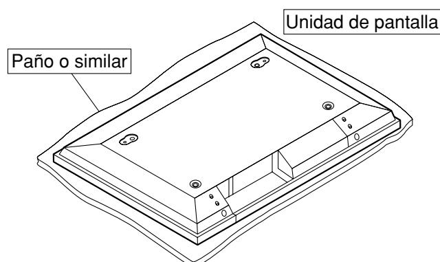
Despliegue un paño o material similar sobre una superficie plana o base y coloque la unidad de pantalla con su cara hacia abajo.
