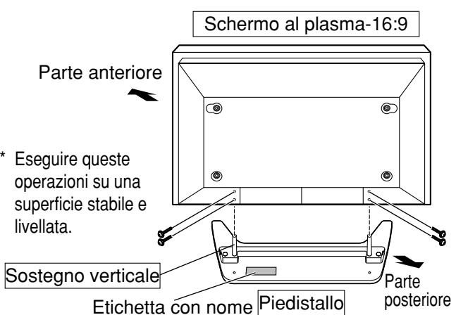
Per un fissaggio accurato, utilizzare le viti di assemblaggio ② (vite nera).
