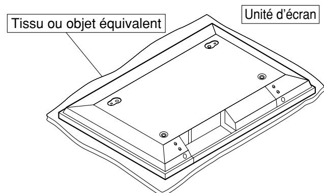
Placez un chiffon propre ou une feuille du même type sur une base ou un plancher horizontal, et mettez l'unité d'écran face vers le bas.
