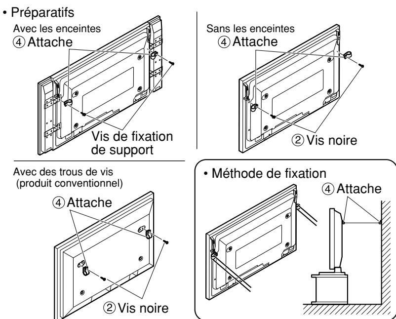
\* Utilisez du fil métallique solide ou une chaîne en vente dans le commerce pour fixer l'Ecran plasma 16/9ème sur une partie solide du mur ou d'un pilier.
