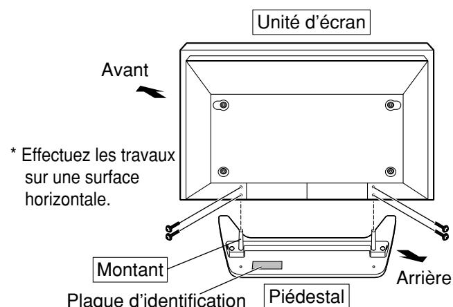
Utilisez les vis de montage ② (vis noire) pour assurer une fixation solide.
