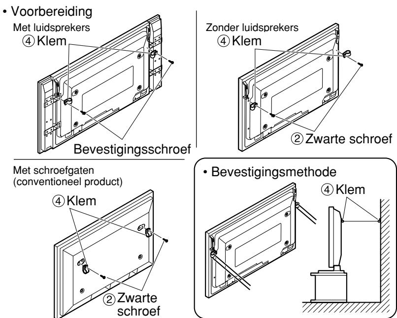
\* Gebruik een stevige in de handel verkrijgbare kabel of ketting om de Breedbeeld Plasmadisplay Monitor aan een solide gedeelte van een muur of pilaar te bevestigen.
