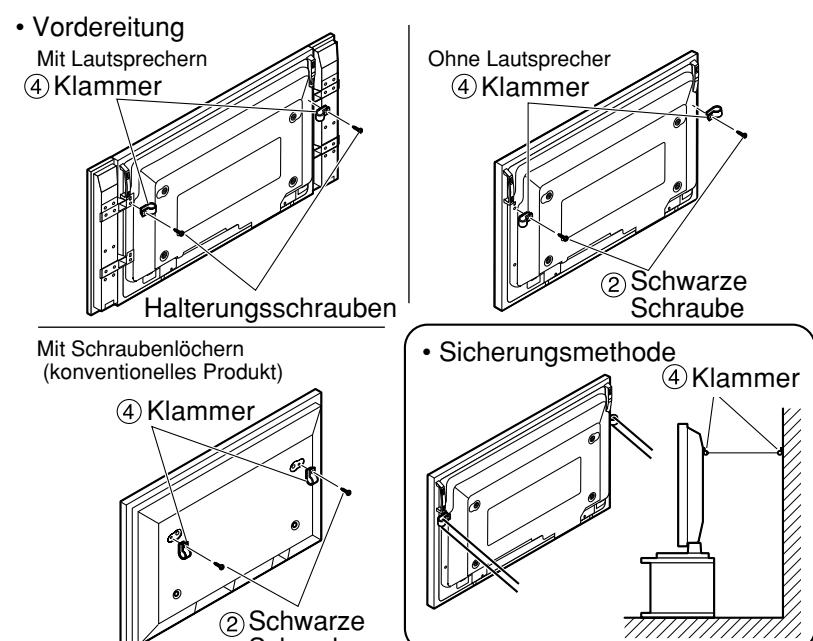
\* Verwenden Sie einen starken Draht oder eine Kette, um das Plasmadisplay an einer festen Stelle an der Wand oder an einer Säule zu sichern.
