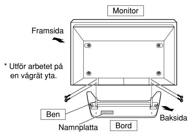
Använd monteringsskruvarna ② (Svart skruv) för att fästa ordentligt.
