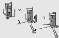
2 Instale la unidad en la base de colocación. Alinee y ponga la unidad en la base de colocación, gire el tornillo hacia la derecha para asegurar la unidad.
