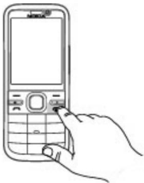
按住电源键可打开或关闭设备。快速按电源键可结束通话或关闭应用程序。
