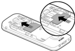
确保 SIM 卡的触点向下朝向设备，并且切角正对着卡夹插槽。
