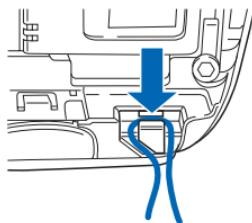
取下手机后盖和电池。如图所示，穿入腕带并将其拉紧。重新安装电池和后盖。
