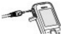
为电池充电时，您不必遵循固定的充电时长，并且可以在充电过程中使用设备。如果电池电量已完全耗尽，则可能需要等待几分钟，屏幕上才会出现充电指示符号，这时您才可以拨打和接听电话。
