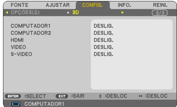
Seleccionar uma entrada ligada a uma fonte de imagens 3D [COMPUTADOR / VIDEO / S-VIDEO] (V230X/V260/V230)/[COMPUTADOR 1/COMPUTADOR 2/HDMI/VIDEO/S-VIDEO] (V300X/V260X/V300W/V260W)
