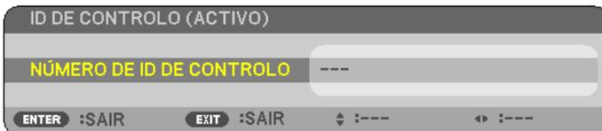
Se o projector puder ser operado com o ID de controlo remoto actual, será apresentado [ACTIVO]. Se o projector não puder ser operado com o ID de controlo remoto actual, será apresentado [INACTIVO]. Para operar o projector inactivo, atribua o ID de controlo usado para o projector utilizando o seguinte procedimento (Passo 3).
