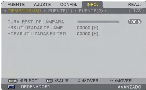
Muestra las horas de utilización de la lámpara, el estado de de la señal y de los ajustes actuales, así como la versión de RED y sus ajustes.
