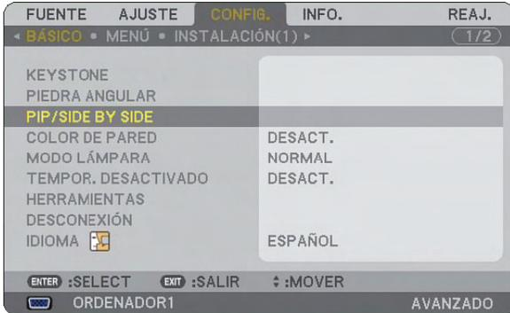
El elemento del menú [PIP/SIDE BY SIDE] tiene las siguientes tres opciones: MODO, POSICIÓN y FUENTE. Utilice el botón SELECT ▲ o ▼ para seleccionar [MODO], [POSICIÓN] o [FUENTE] y pulse el botón ENTER.
